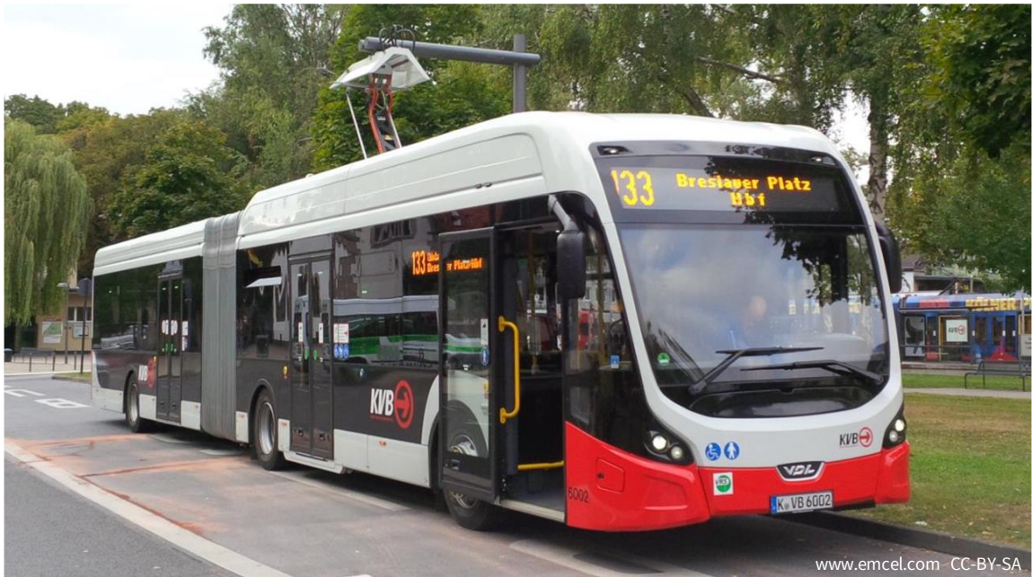
Abbildung 2-3 Ein E-Bus beim Laden mittels Pantografen
